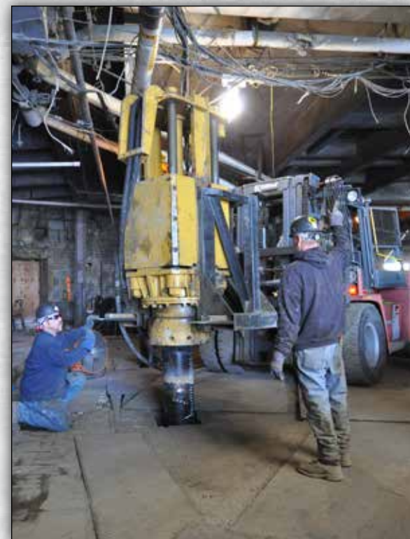
MARTILLO DE IMPACTO HIDRÁULICO 7.5 MONTADO EN MONTACARGAS.
