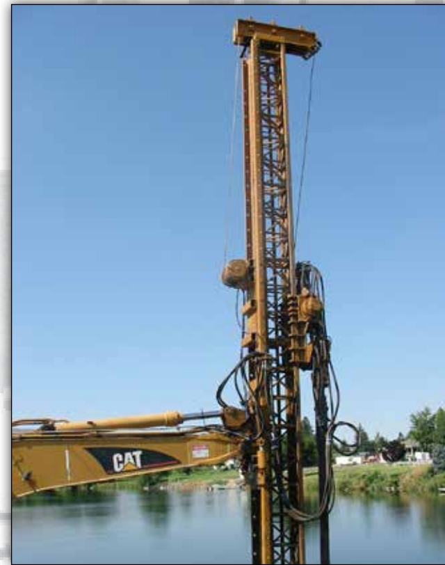
EL SISTEMA DE DESLIZAMIENTO DE CREMALLERA Y PIÑÓN CON UNA PERFORADORA MODELO 30 Y UNA PERFORADORA DE PERCUSIÓN DEL FONDO ADCOCK.
