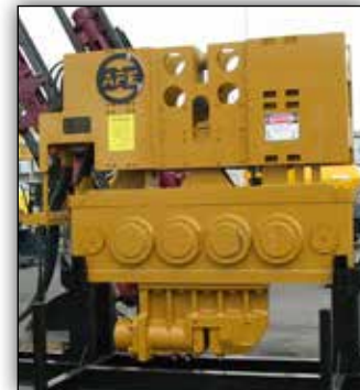
VIBRADOR MODELO 200 CON UNA ABRAZADERA DE HOJA MODELO 200 EQUIPADA CON MORDAZAS DE HOJA DOBLES.
