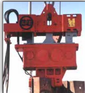
VIBRADOR MODELO 150T CON ABRAZADERA MODELO 150.
