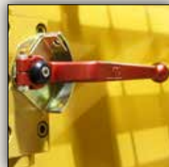
VÁLVULA DE TRANSFERENCIA DEL TANQUE PARA REABASTECER EL LÍQUIDO HIDRÁULICO
